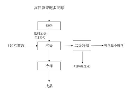
图 2-2 运营期工艺流程及产污环节图
