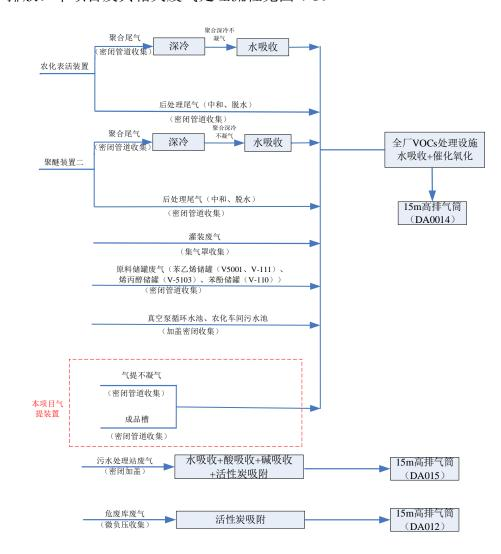
图 4-1 本项目及其相关废气处理流程图
