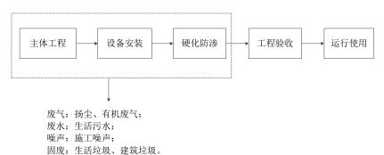
图 2-1 施工期工艺流程及产污环节示意图
