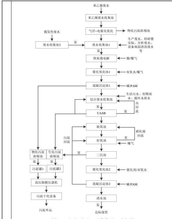
图2-6 厂区污水处理站收集处理流程图
