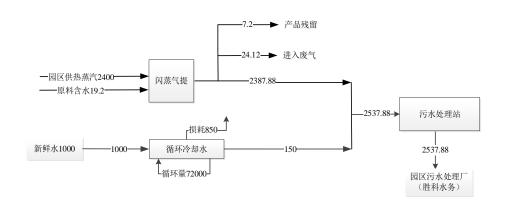
图 2-5 本项目水平衡 (t/a)
