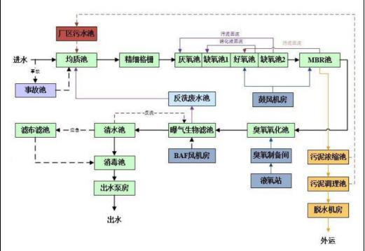
图4-4 南京胜科水务有限公司拟建工程流程图 ②接管可行性分析
