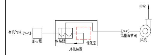
表4-2 催化氧化装置工艺流程示意图
